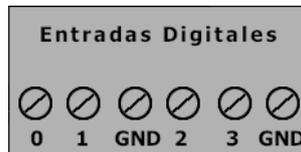
Entradas digitales. Niveles lógicos: 0~0.5V o circuito a cerrado se trata como cerrado. +3~30V or circuito abierto se trata como abierto. Las entradas pueden ser utilizadas como contador, la frecuencia de muestreo es 1Khz. Solo la primera entrada puede utilizarse como contador de pulsos.
